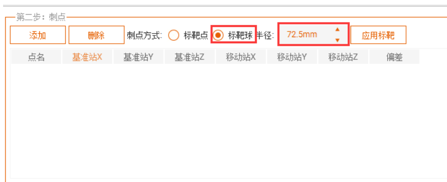
图 3-39 选择刺点方式（注：标准靶球半径为 72.5mm）
